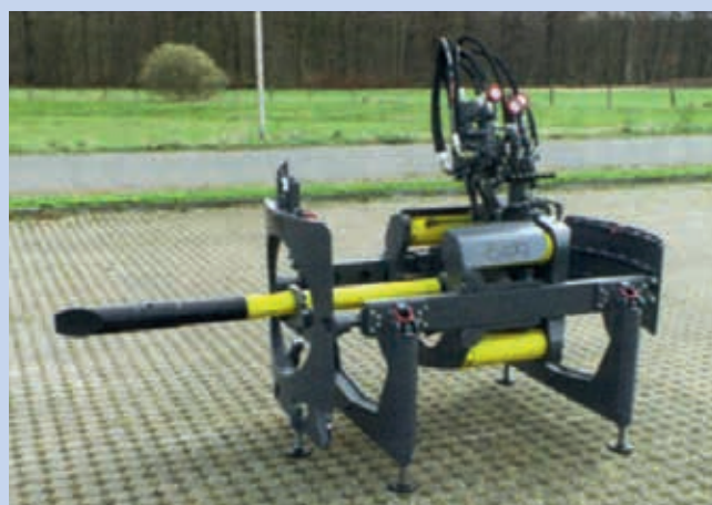
Ryc. 7. Maszyna do przecisków hydraulicznych PBA 125, mts Perforator [5]
