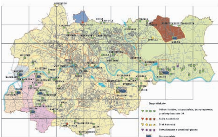
Ryc. 3. Schemat systemu kanalizacyjnego Krakowa z zaznaczonymi punktami monitoringu
