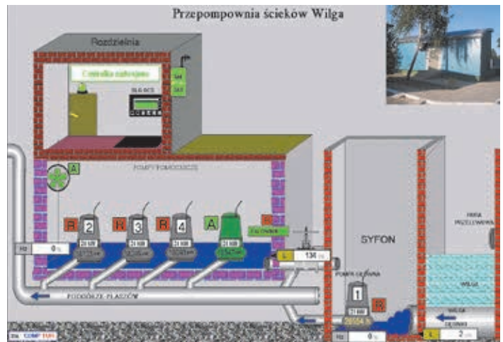
Ryc. 1. Układ technologiczny pompowni ścieków Wilga
