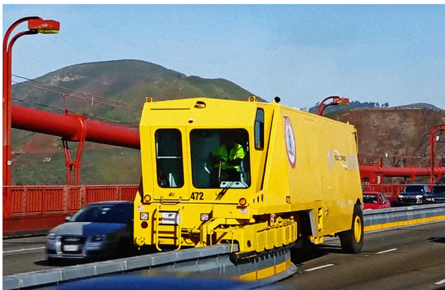
Specjalne pojazdy do przestawiania barier rozdzielających pasy ruchu w systemie Road Zipper, źródło: Lindsay
