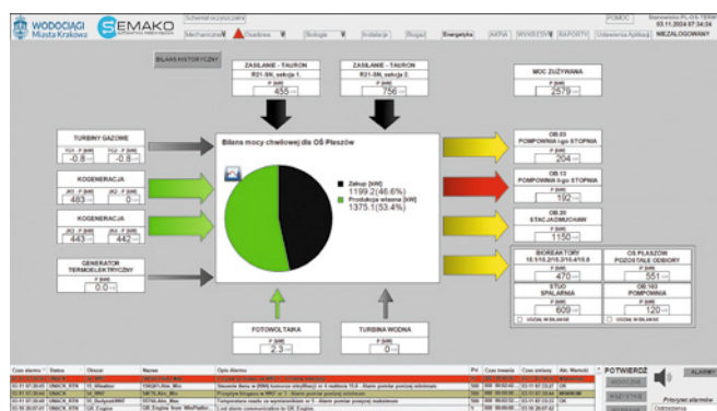
Chwilowy rozkład energii pobieranej przez oczyszczalnię Płaszów. Na zielono zaznaczono ilość wytwarzanej energii
