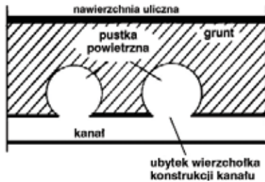
Rys. 12. Puste przestrzenie powietrzne tworzące się w gruntach spoistych nad brakującymi fragmentami górnej części konstrukcji kanału
