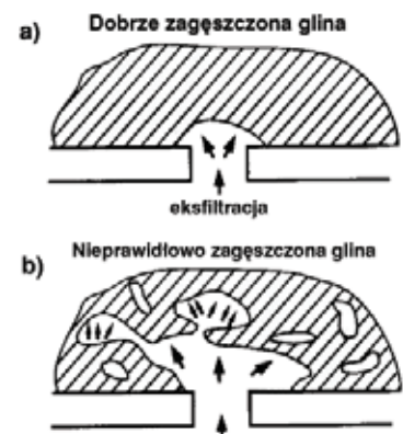
Rys. 11. Zjawisko erozji gruntu spoistego do wnętrza kanału
