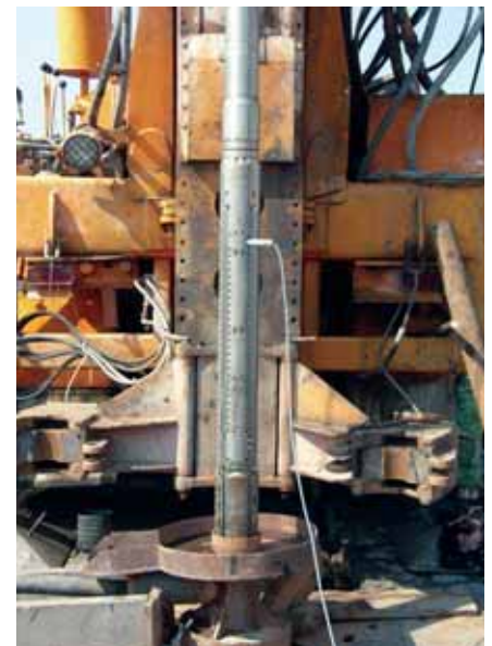
Żerdź do wiercenia kierunkowego podczas programowania
