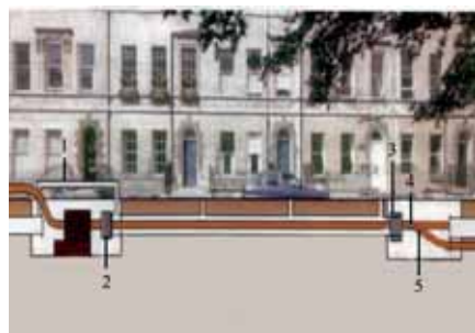
Rys. 6. Idea odnowy czynnego przewodu rurą PE [13]:
