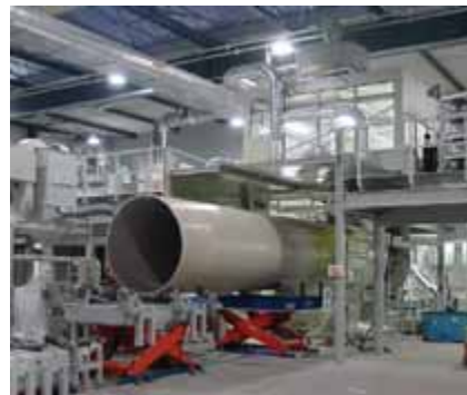
Rys. 2. Ciągła nawojowa produkcja rury przewodowej i części łącznikowej, CW 2400
