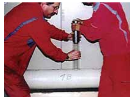
Rys. 10. Testowanie rury dwuosiowej DN 150 PN 16, badanie zachowania pod wpływem udaru przeprowadzone po kontrolowanym teście ciśnieniowym [2]
