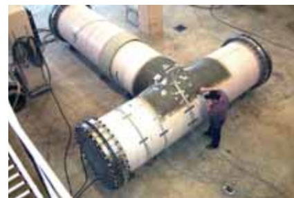
Rys. 9. Testowanie kołnierzowego dwuosiowego połączenia trójnikowego DN 1200 PN 6 z połączeniem blokowanym klinowo do późniejszego wykorzystania w projekcie rurociągu odpornego na działanie sił osiowych w Goochland, Virginia, USA [2]
