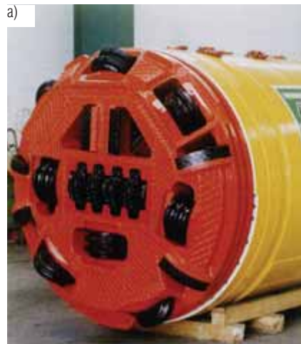
Rys. 4. Przekrój przez urządzenie do mikrotunelowania z płuczkowym systemem usuwania urobku [5]
