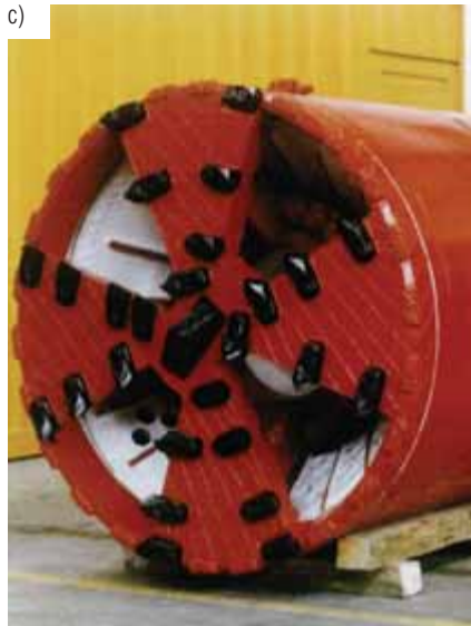
Rys. 5. Różne rodzaje tarcz urabiających w zależności od rodzaju gruntu [5] a) tarcza do skał, b) tarcza do gruntów skalistych i spoiстых, c) tarcza do gruntów sypkich
