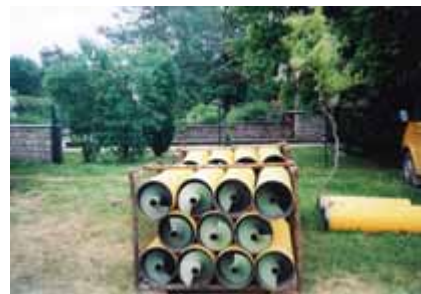
Rys. 12. Stalowe rury osłonowe firmy Perforator z założonymi elementami przenośnika ślimakowego (zdjęcie własne)
