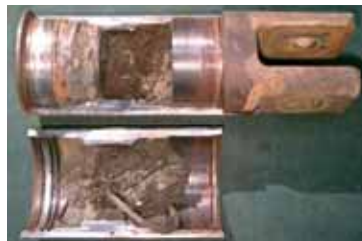
Fot. 4. Łącznik obrotowy poszerzacza wiertniczego po przecięciu ze zniszczonymi elementami łożyska, urwanym wałem, uszczelnieniami i resztkami smaru
