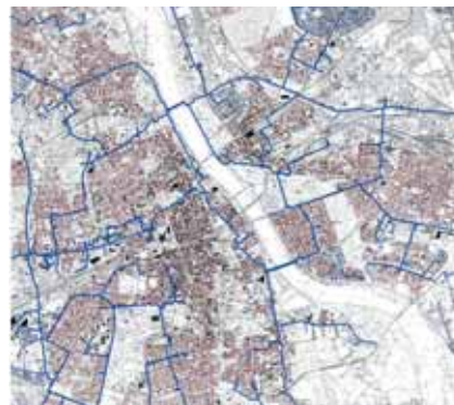
Mapa fragmentu sieci gazowej Warszawy z gazociągami przekraczającymi Wisłę
