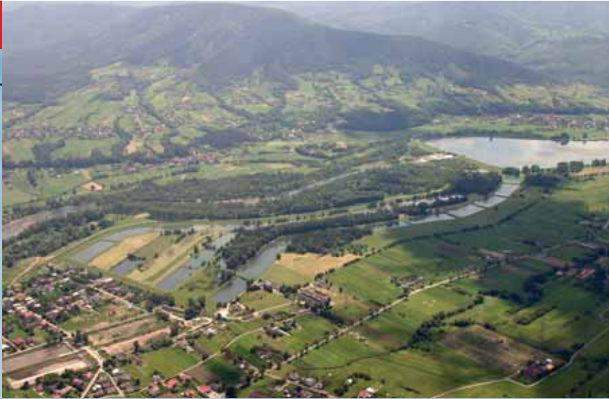
Układ stawów infiltracyjnych na ujęciu wody w Kobiernicach. W tle zbiornik w Czańcu
