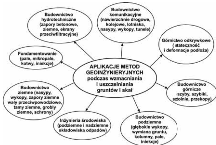
Rys. 1. Zakres aplikacji metod geoinżynierskich podczas wzmacniania i uszczelniania ośrodka gruntowego
