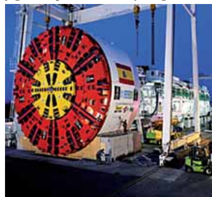
Rys. 2. Tarcza urabiająca zastosowana przy projekcie M-30 w Madrycie [3]
