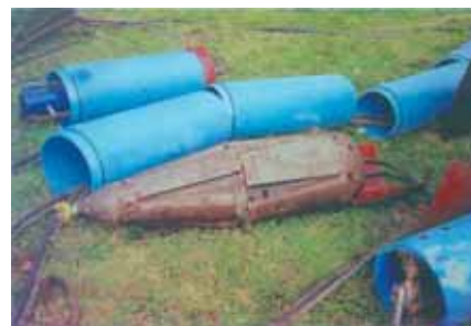
Rys. 5. Zdjęcie głowicy powiększającej oraz krótkich modułów wykonanych z rur PE-MD firmy Wavin zastosowanych w 1992 r. do bezwykopowego powiększenia przewodów kanalizacyjnych ze średnicy 200 mm na średnicę 315 (fot. ze zbiorów autora)
