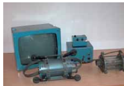
Rys. 1. Pierwsza polska kamera do badań inspekcyjnych kanałów techniką video (fot. ze zbiorów autora)
