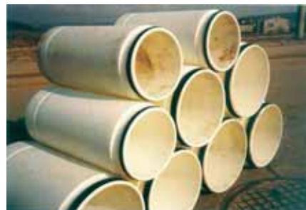
Rys. 4. Zdjęcie krótkich modułów rur PE-HD firmy KWH-Pipe sprowadzonych w 1991 r. z Finlandii do renowacji przewodów kanalizacyjnych w Tarnowie (fot. ze zbiorów autora)
