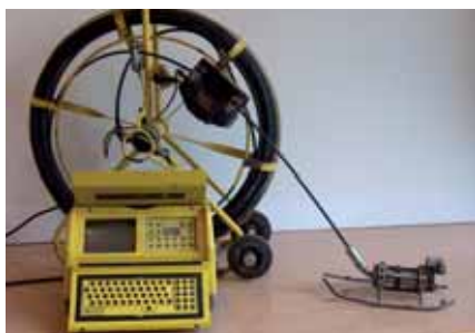
Rys. 2. Kamera firmy Pearpoint Ltd. zakupiona przez Politechnikę Świętokrzyską (fot. ze zbiorów autora)
