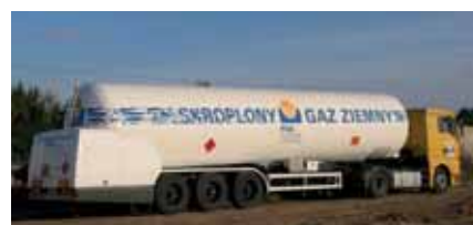
Ryc. 4. Cysterna o pojemności 43 m 3
