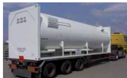
Ryc. 3. Cysterna kontenerowa o pojemności 32 m 3
