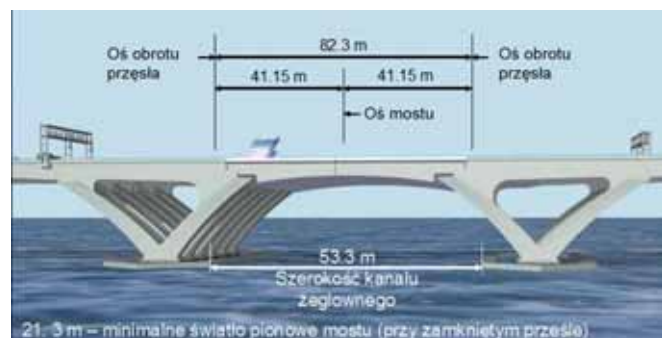
Fot. 5. Parametry balastowanych prześel podnoszonych
