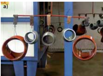
Ryc. 9. Kształtka żeliwna: a) zabezpieczona zewnętrzną i wewnętrzną antykorozyjną powłoką ochronną, b) bez zabezpieczenia antykorozyjnego [3]
