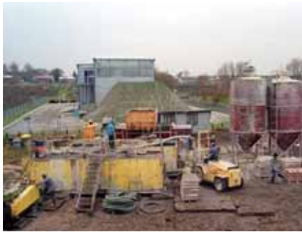
Rys. 3. Węzeł do wytwarzania zawiesiny twardniejącej
