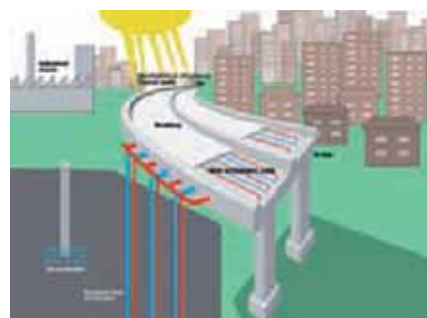
Rys. 2. Efekt działania układu odśnieżania mostu za pomocą ciepła oraz schemat systemu [3]
