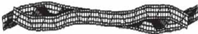
Rys. 5. Wygięcie poprzeczne półki w dwuteowych dźwigarach ze środnikiem trapezowym, wyznaczone metodą elementów skończonych [6]
