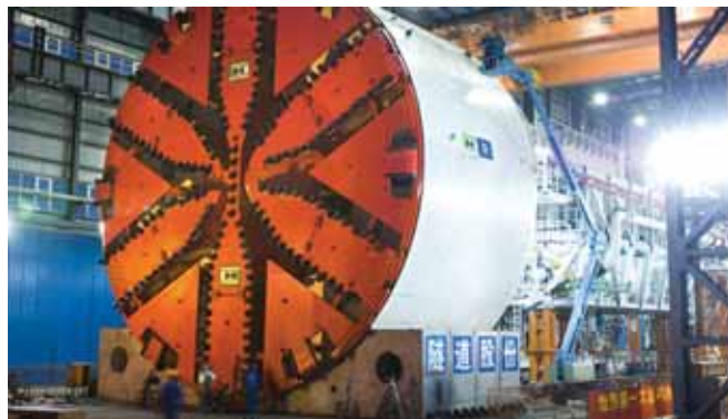
Rys. 3. Największa tarcza TBMs firmy Herrenknecht Ø 15,43 m [2]
