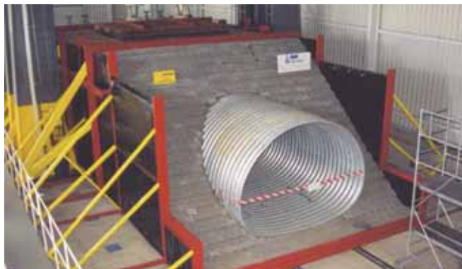
Rys. 8. Badanie konstrukcji nowoczesnego przepustu na standzie badawczym w skali naturalnej, fot. A. Wysokowski
