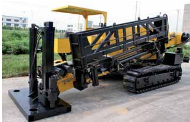
Rys. 2. Nakładki gumowe zamontowane na gaśienicach wiertnicy ZT-25ADF, umożliwiające prace maszyny w warunkach miejskich
