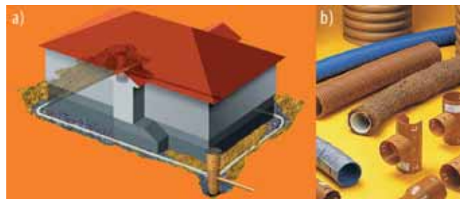
Przykłady elementów systemów drenarskich: a) drenaż opaskowy budynku, b) rury i kształtki drenarskie PVC
