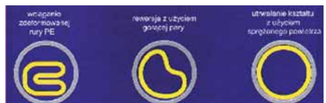
Rys. 2. Schemat przebiegu renowacji metodą U-Liner [6]
