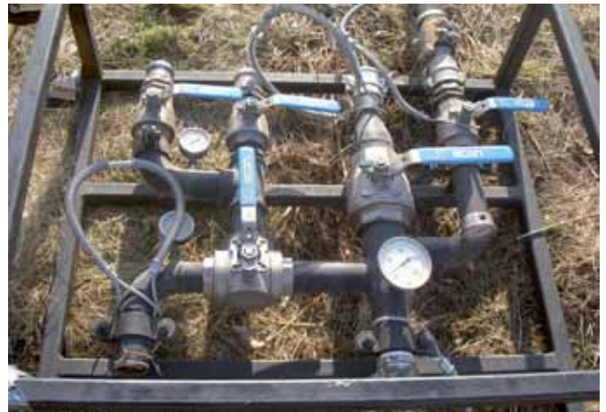
Fot. 4. Zestaw zaworów do regulacji i kontroli procesu wprowadzania rękawa
