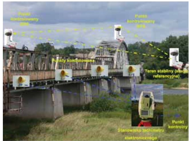
Ryc. 6 Schemat realizacji monitoringu mostu na przykładzie podzielonogórskich Cigacice; źródło: Leica Geosystems Sp. z o.o.
