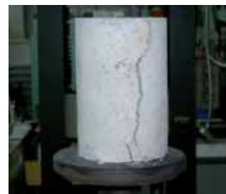
Badanie „na zimno” – przykład typowego zniszczenia, stal A, temperatura 700 °C
