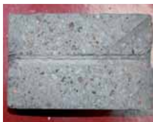
Przykład próbki po badaniu z widocznym kanałikiem, w którym umieszczano termoparę mierzącą temperaturę na styku zbrojenie – beton
