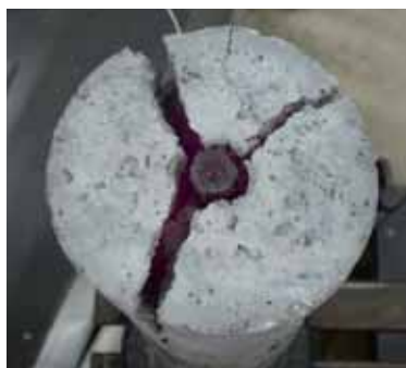
Badanie „na gorąco” – przykład typowego zniszczenia, stal C EPSTAL®, obciążenie 12 kN
