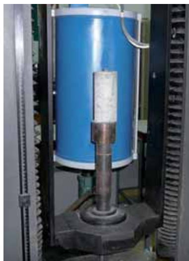
Badanie „na gorąco” – widok próbki przed badaniem. W tle cylindryczny piec, w którym umieszczana jest próbka
