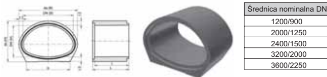
Ryc. 6. Przykład nowoczesnych elementów żelbetowych (o kształcie gardzielowym) firmy Haba-Beton Sp. z o.o. do budowy przepustów
