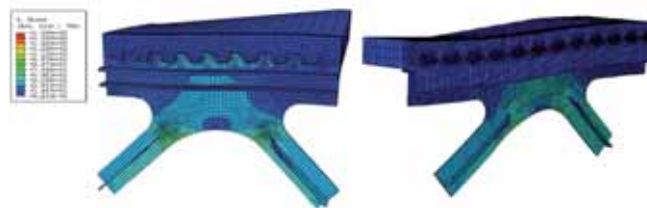
Ryc. 16. Model węzła kratownicy z wizualizacją naprężeń Misesa: a) model wylinkowy o skróconej długości pasa górnego, b) model o rzeczywistej długości pasa górnego
