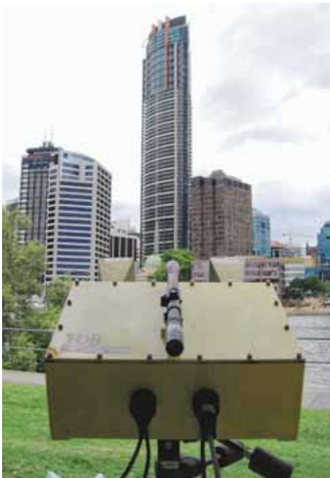
Ryc. 2. Monitoring całego budynku przy użyciu radaru IBIS-S
