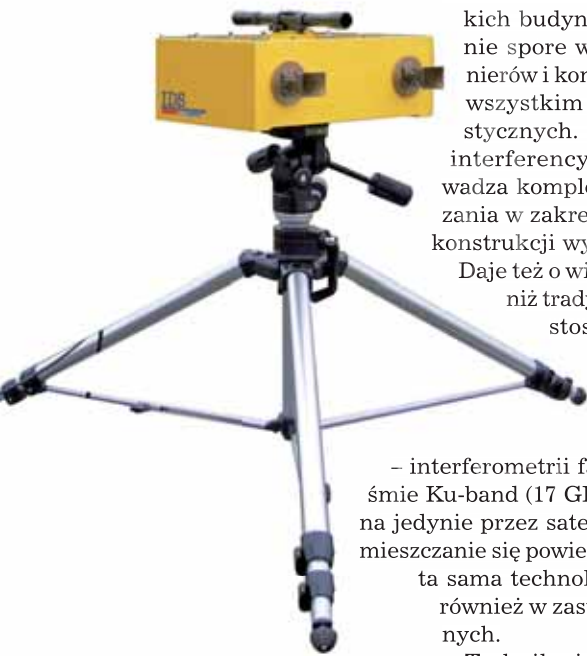
Ryc. 1. Radar interferencyjny IBIS-S
