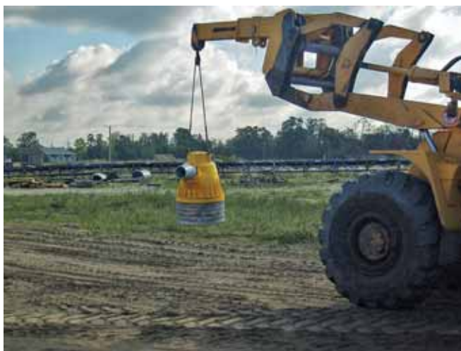
Ryc. 2. Największa pompa odwodnieniowa PX30 pracująca na południu Polski
