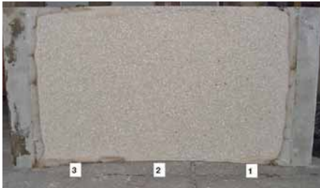
Próba ogniowa – obudowa tunelu z włóknami polipropylenowymi po próbie ogniowej
