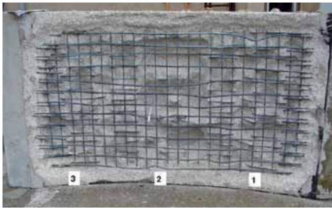
Próba ogniowa – obudowa tunelu bez włókien polipropylenowych
