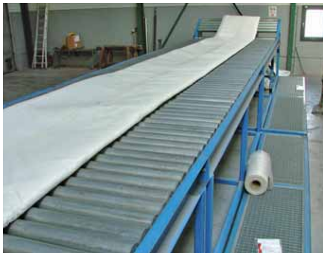
Rękaw na linii do nasączenia
