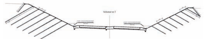
DE S1 – Schemat zabezpieczenia skarp osuwiskowych
