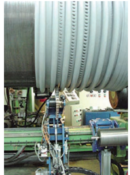
Ryc. 5. Etap wykonywania rury z PEHD. Widoczny proces nawijania dodatkowej warstwy (karbów) podnoszącej właściwości mechaniczne rury, fot. Polyteam Sp. z o.o.
