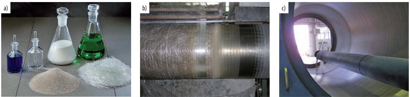
Ryc. 12. Produkcja rur z tworzywa GRP: a) surowce do produkcji rur z tworzywa GRP, b) produkcja metodą nawojową, c) produkcja metodą odlewania odśrodkowego CC
