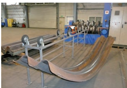
Ryc. 23. Element przepustu Multiplate o dużej średnicy wykonany ze stalowych blach falistych w fazie walcowania w firmie ViaCon, fot. A. Wysokowski
