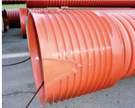
Ryc. 9. Połączenie kielichowe stosowane w przepustach z PP produkcji firmy Wavin, fot. A. Wysokowski
