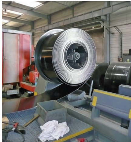
Ryc. 17. Taśma stalowa do wykonywania karbowanych rur spiralnych w trakcie wykorzystywania do produkcji w firmie ViaCon, fot. A. Wysokowski
