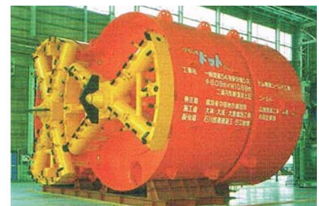
Ryc. 4. Urządzenie DOT zastosowane do budowy tunelu komunikacyjnego Hiroshima Astram [3]
