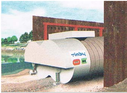
Ryc. 10. Urządzenie TIMBY, składające się z dwóch części, tworzących podwójną tarczę [1]
