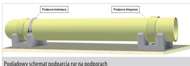
Poglądowy schemat podparcia rur na podporach
