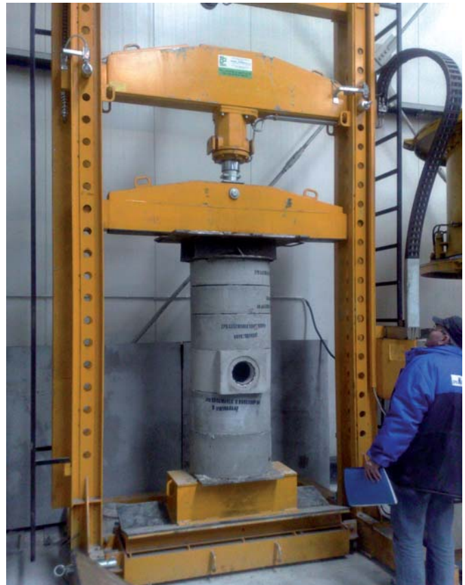
Ryc. 3. Badanie na siłę pionową betonowej zwężki DN 1000 oraz wpustu ulicznego DN 500 w Laboratorium ZPB Kaczmarek
