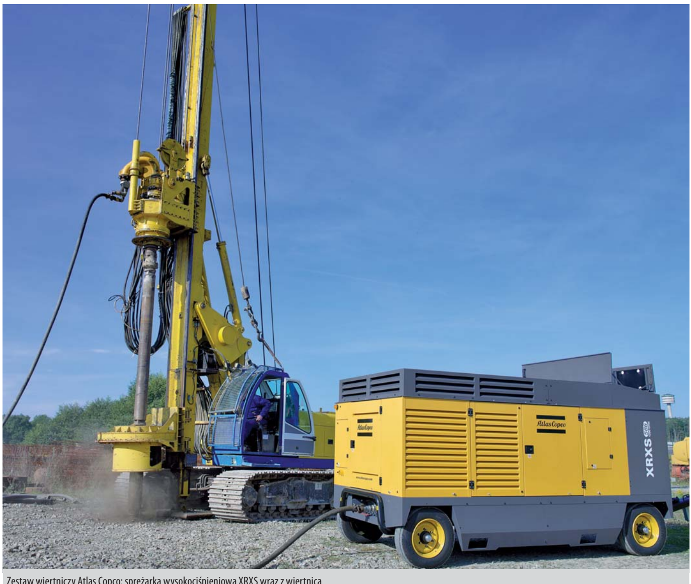
Zestaw wiertniczy Atlas Copco: sprężarka wysokociśnieniowa XRXS wraz z wiertnicą
