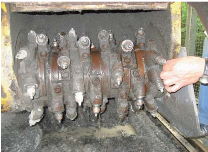
Ryc. 4. Wygląd frezów po sfrezowaniu nawierzchni z kompozytem HaTelit C 40/17
