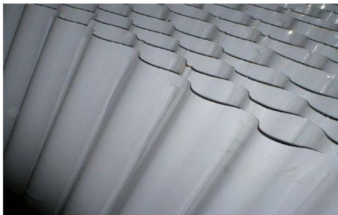
Ryc. 5. Przykład wkładu wielostrumieniowego (oferta firmy Oczyszczalnie Ścieków HALSON) [9]
