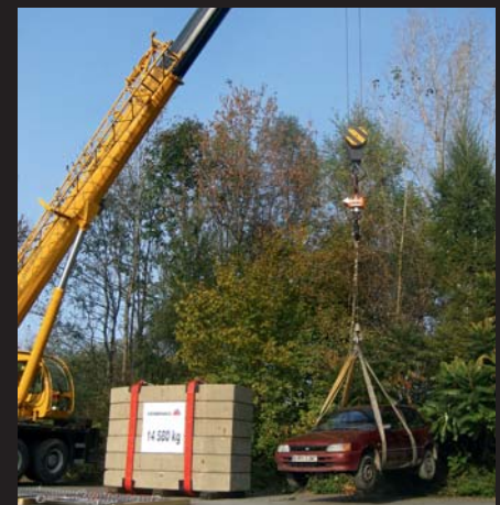
Samochód osobowy wiszący na drucie stalowym o średnicy 3 mm oraz ciężar gotowy do pokazu wytrzymałości siatki TECCO®
