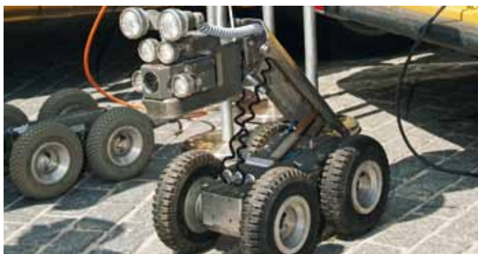
Robot z kamerą, dzięki któremu można dokładnie obejrzeć stan rur kanalizacyjnych bez potrzeby ich rozkopywania
