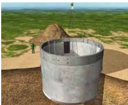
Ryc. 1. Żelbetowy pierścień początkowy z nożem tnącym [1]
