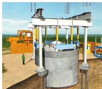
Ryc. 3. Konstrukcja wsporczą ramy przeciskowej [1]
