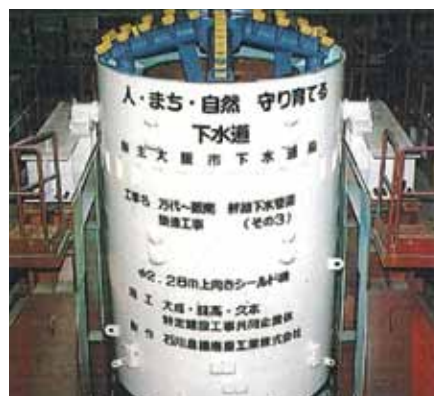
Ryc. 12. Widok urządzenia w kombinacji wiercenie poziome – wiercenie pionowe do góry ( horizontal – vertical upward ) [2]
