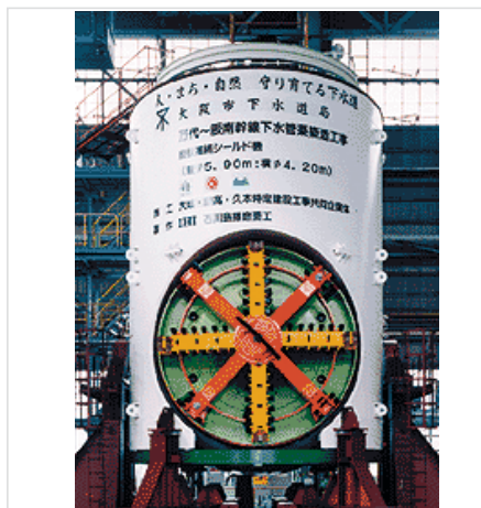
Ryc. 10. Widok tarczy sferycznej przystosowanej do kombinacji wiercenia pionowo w dół – poziomo ( vertical downward – horizontal ) [2]
