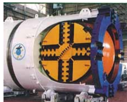
Ryc. 8. Widok tarczy sferycznej z obrotowym członem [3]
