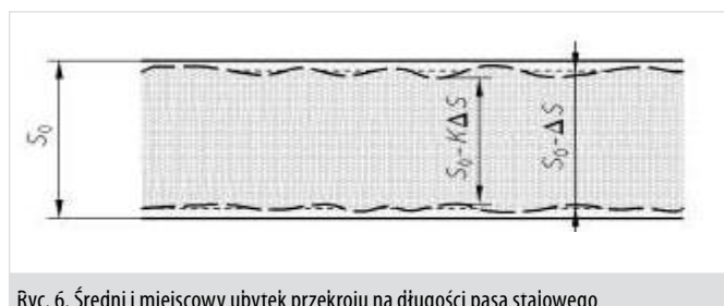
Ryc. 6. Średni i miejscowy ubytek przekroju na długości pasa stalowego
