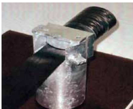
Ryc. 4. Głowica kotwiąca i stalowy blok w systemie Stress-Head (CarboDur 60 x 2,4 mm), fot. M. Łagoda
