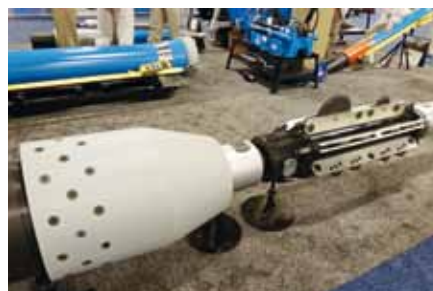
Ryc. 9. Urządzenie stosowane w technologii berstliningu
