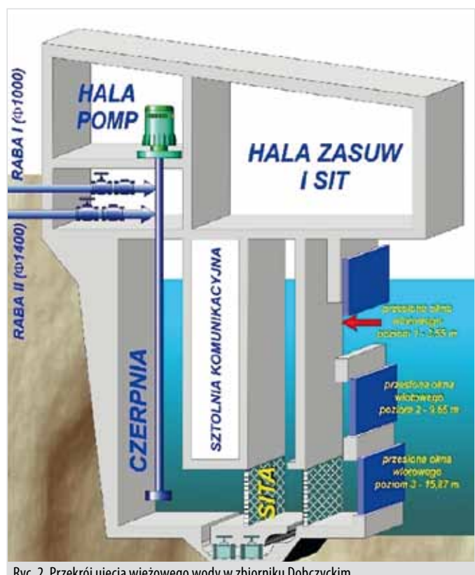
Ryc. 2. Przekrój ujęcia wieżowego wody w zbiorniku Dobczyckim
