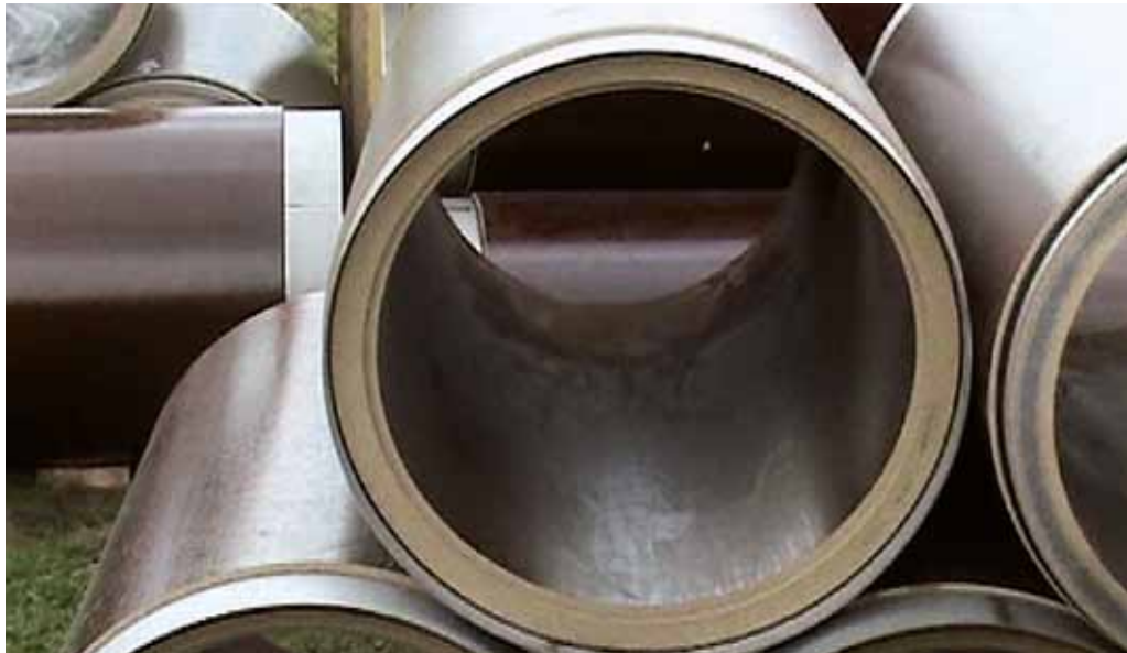
Ryc. 7. Rury kamionkowe DN 800 (Gdańsk, 2007) układane pod płytą lotniska [4]
